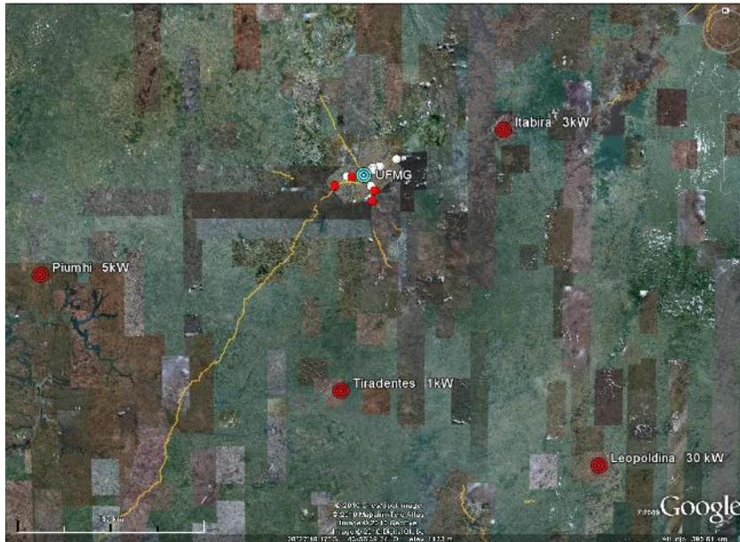
Figura 10 – Medições com interferências em 104.3 MHz e possíveis estações interferentes
