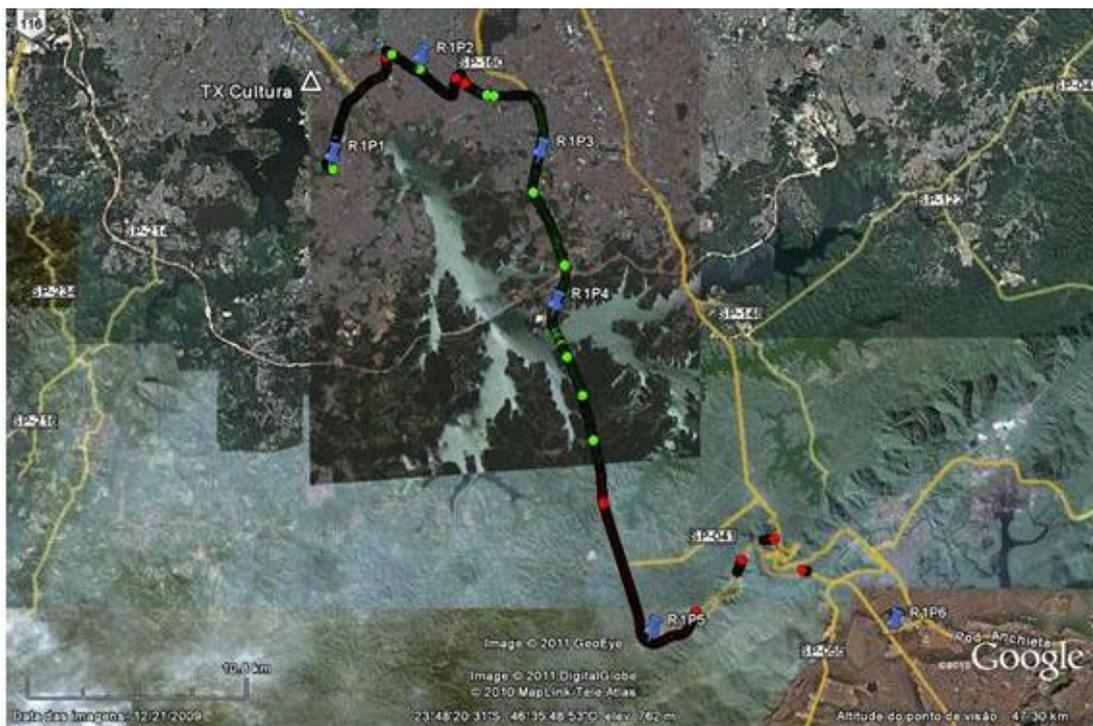
Figura 18-Parâmetro SNR medido na rota R1- 64QAM
