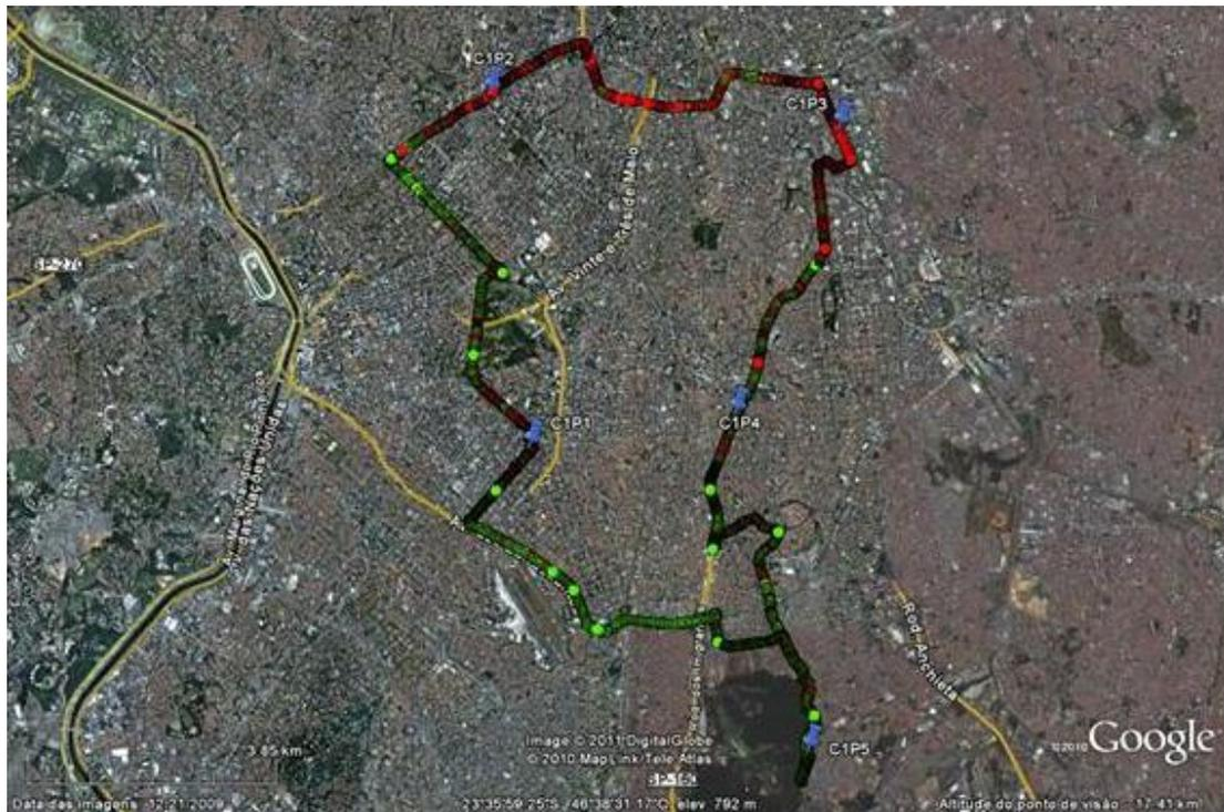
Figura 2 - Parâmetro SNR medido na rota C1 - 16QAM
