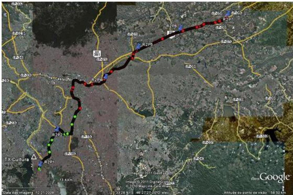
Figura 22-Parâmetro SNR medido na rota R2 64QAM
