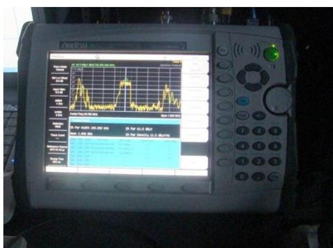
Figura 7 – Analisador de Espectro Anritsu MS2711D
