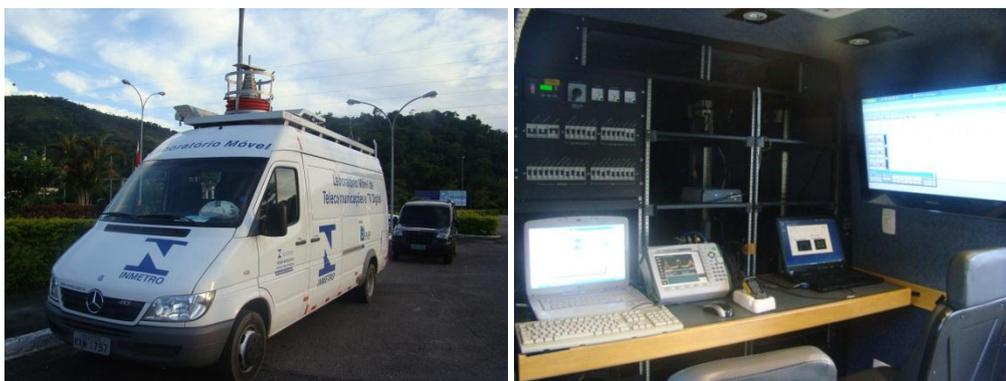
Figura 6 – Laboratório móvel de telecomunicações do Inmetro
