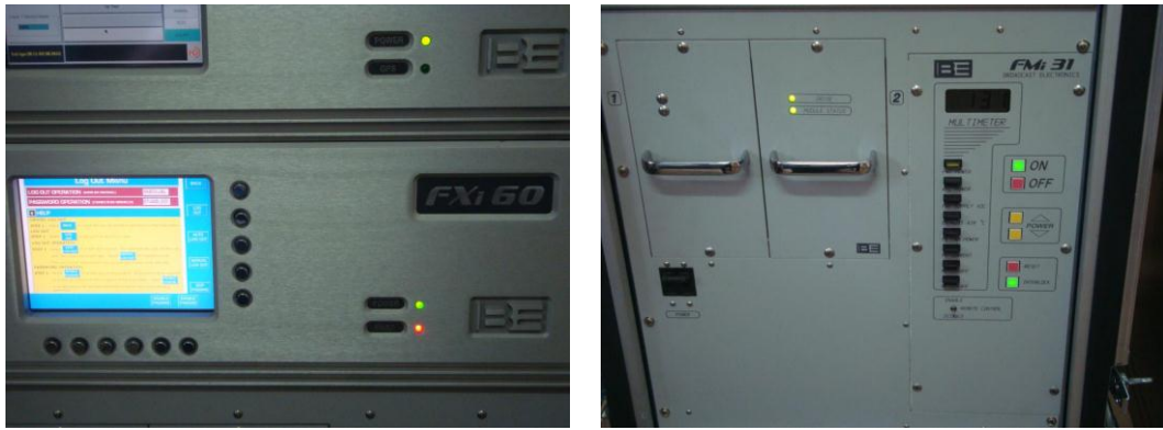
Figura 6 – Detalhe do excitador (esq.) e dos amplificadores (dir.).
